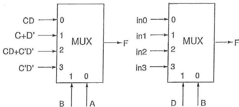
Met behulp van een multiplexer wordt de functie  $F(A, B, C, D)$  gemaakt. Wat moet er als in2 worden aangeboden om voor beide MUX schakelingen identieke uitgangen  $F(A, B, C, D)$  te realiseren?
