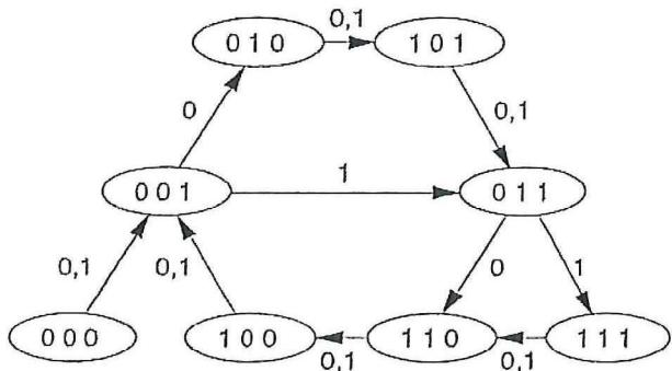
Van een schakeling opgebouwd uit 3 JK FLIP-FLOPS C, B en A en een ingangssignaal S is het gecodeerde toestandsdiagram hiernaast gegeven. Uit de coderingen CBA is te zien dat C en B direct bestuurd worden door respectievelijk B en A (schuifregistersekties). Bepaal de sturing van de JK FLIP-FLOP A.
