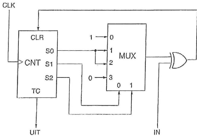
Het gegeven schema bestaat uit een 3-bits binaire teller, een multiplexer met 4 data-ingangen, en een poort. De CLR-ingang van de teller is synchroon, dus het resetten wordt pas geëffectueerd op de klokpulse. Als de teller wordt gestart in de 0 0 0 stand, welke ingangsbitreeks  $b_0 b_1 b_2 \dots b_5 b_6$  zal een 1 bij de uitgang UIT geven? ( $S_0$  is het laagstwaardige bit van de teller)
