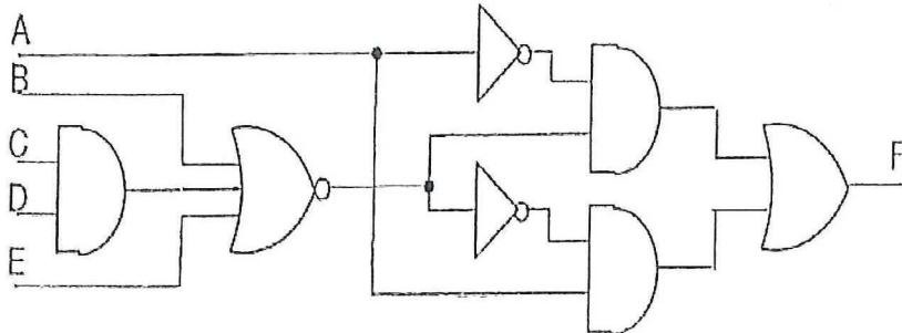
Wat is de netwerkvertraging  $t_{PLH}$  van nevenstaande schakeling als gegeven is dat de output load van de schakeling 1 is ? (Maak gebruik van de tabel op deze pagina)
