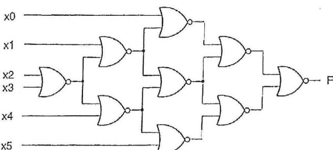
Bepaal de  $F(x_5, x_4, x_3, x_2, x_1, x_0)$  van nevenstaand poortnetwerk.
