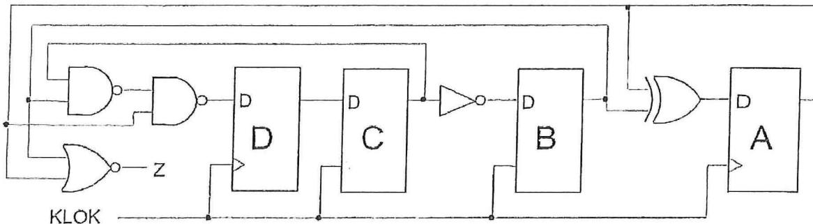
Bovenstaand schema is opgebouwd uit 4 D-flipflops en enkele poorten, en heeft een uitgang z. Als de periodeduur van de klokpuls  $T_p$  is, wat is dan de tijdsduur tussen 2 opgaande flanken van het uitgangssignaal z uitgedrukt in  $T_p$ ? (Hint: Start in stand DCBA = 0001)
